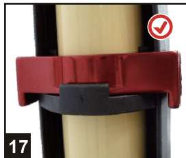
17 Q/R 락킹 레버 세이프티 ( 부품번호.322-4-2 ) 가 정확한 위치로 장착 되었는지 확인한다.
