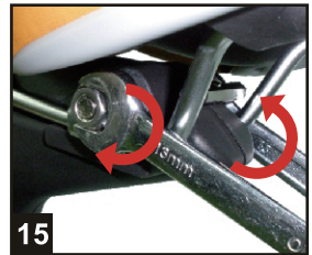
15 13mm 스패너로 조인다. 이때 너무 필요 이상의 힘으로 조이지 않는다. ( 250-350 kgf.cm / 25-35 Nm )
