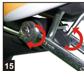
15 用13mm開口板手鎖緊。 (鎖緊度為250~350 kgf)
