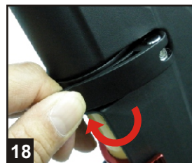
18 快拆柄確實鎖緊，騎乘時座墊盒不可晃動為標準。 依騎乘荷重，調整快拆鬆緊，緊度須以安全作為優先考量。
