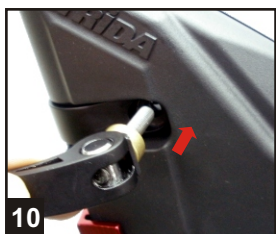
10 將快拆鋁束合起後，上快拆柄螺絲從L邊穿過。
